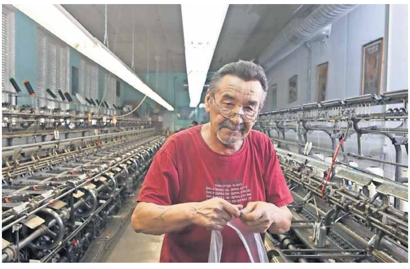
Die zickige alte Dame im Herzen der Fabrik: Die Reading, eine 17 Meter lange amerikanische Strumpfmachine, wurde kurz nach dem Zweiten Weltkrieg gebaut und produziert seither 150 Strumpfpaaere am Tag. Vorausgesetzt, der Arbeiter Eduardo Majchrowski (unten) hält sie bei Laune.
