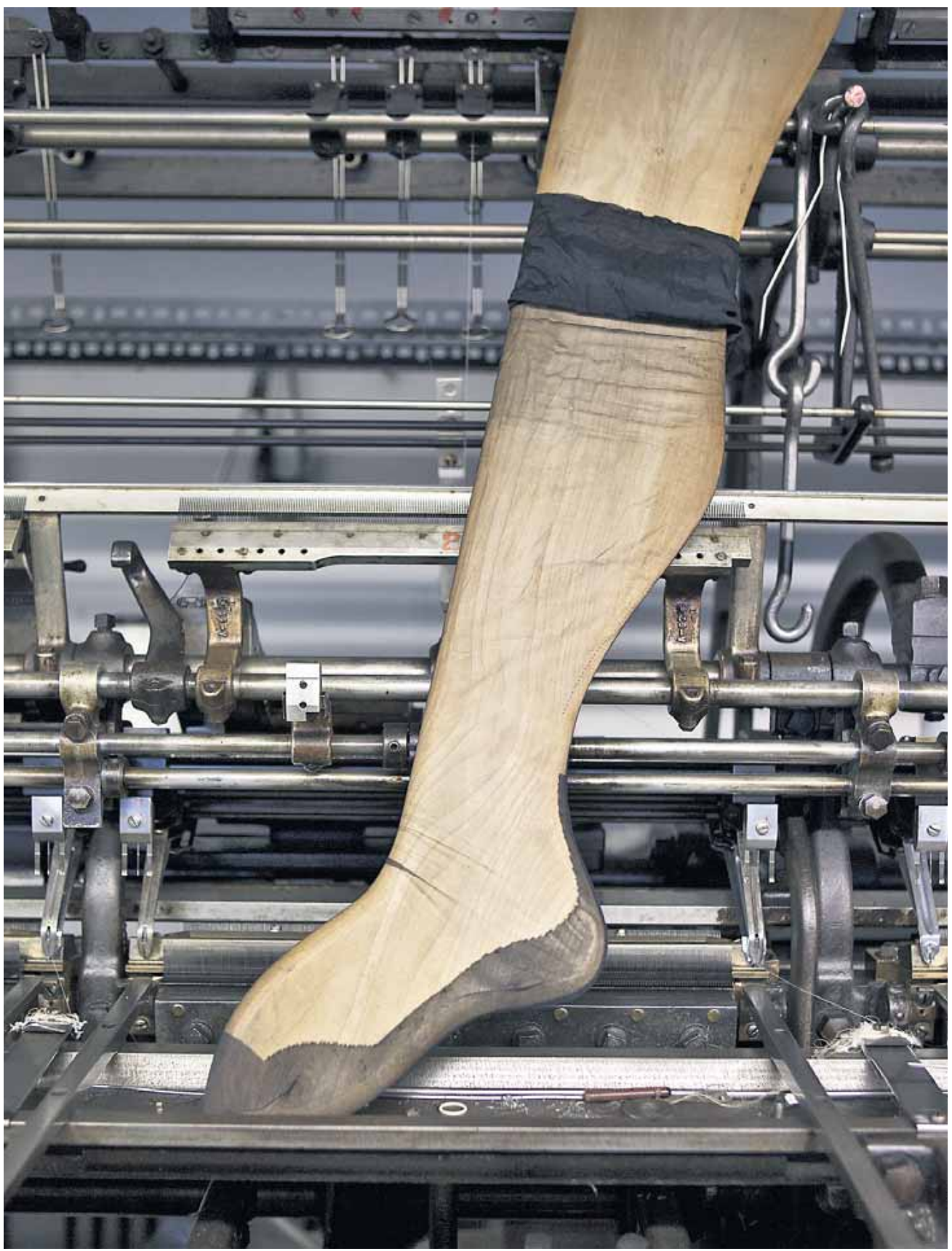
Die zickige alte Dame im Herzen der Fabrik: Die Reading, eine 17 Meter lange amerikanische Strumpfmachine, wurde kurz nach dem Zweiten Weltkrieg gebaut und produziert seither 150 Strumpfpaaere am Tag. Vorausgesetzt, der Arbeiter Eduardo Majchrowski (unten) hält sie bei Laune.
